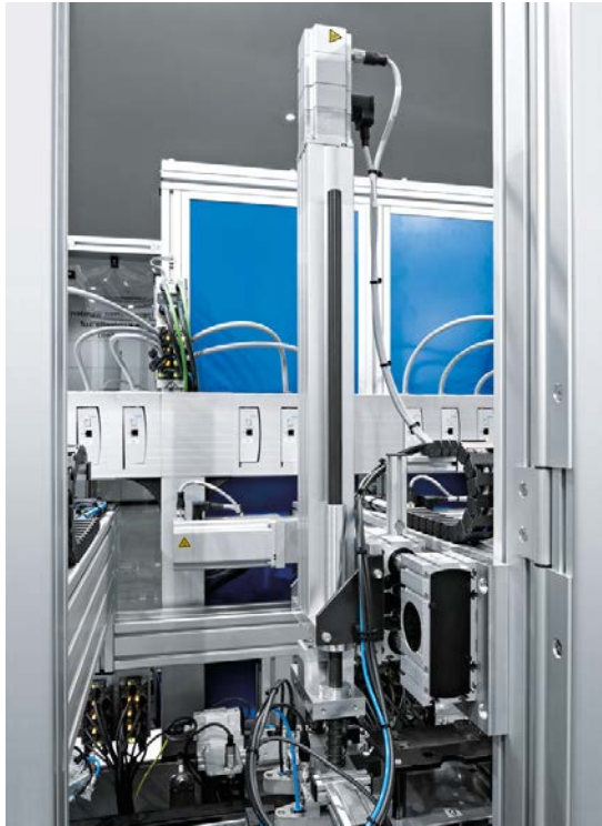
Magazinierung der Bipolarplatten: Die Schrittmotoren des Elektrozyinders EPCO und der Zahnriemenachse ELGR im Handling werden durch Servocontroller CMMO-ST angesteuert.
