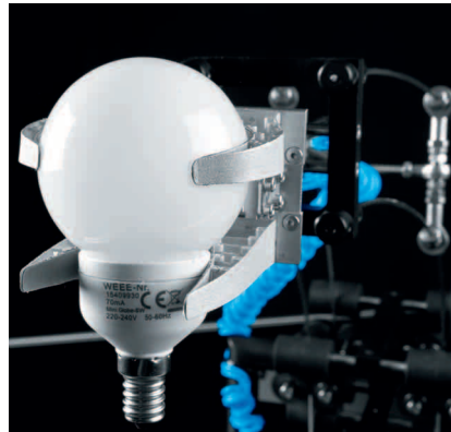
Adaptiver Greifer: formschlüssig und sanft dank Struktur mit Fin Ray Effect®
