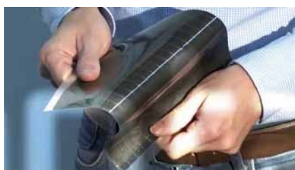
Eine dreilagige Folie weist die gleichen Effekte auf wie schwere Parabolspiegel.
