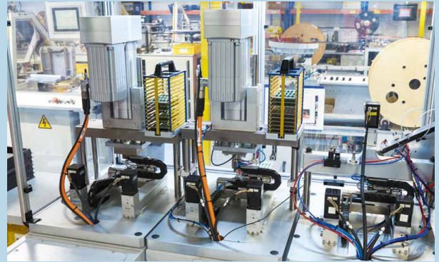
Estructura modular: las tres estaciones de la línea de montaje de conectores Gecko para la inserción, el prensado y el doblado de pines de contacto, diseñadas a partir de componentes estándar de Festo.
