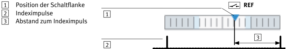
Fig. 2.3 Ausrichtung des Referenzschalters bei Indexauswertung
