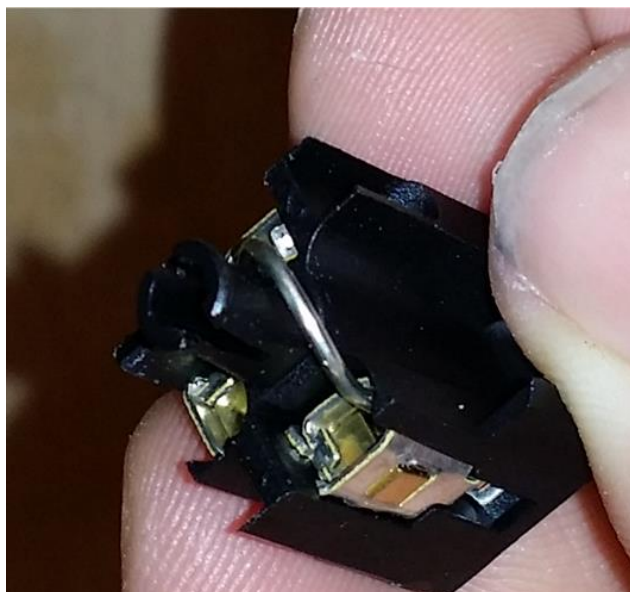
Abbildung 8 : Auslieferungszustand PDAD: Drahtbrücke zwischen Klemme 1 und 2 im Einsatz des DIN- Steckers
