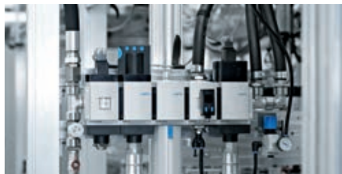
Wartungsgeräte-Kombination mit MS9-SV-C im Einsatz
