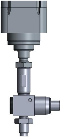
Abb. 3 Einbausituation Sensor SKDA-1.5-AB
