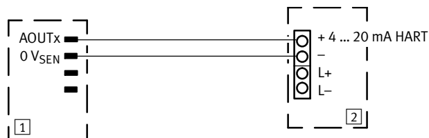
Fig. 15 Raccordement à 2 fils d'un actionneur HART passif
