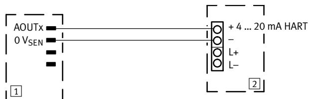
Fig. 15 Conexión de 2 hilos de un actuador HART pasivo
