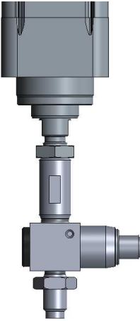
Abb. 3 Einbausituation Sensor SKDA-1.5-AB
