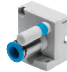
Endplatte mit QS-Anschluss G1/4 für gefasste Abluft oder Vakuum
