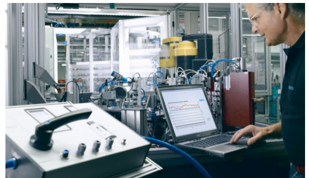
Abbildung 11: Messung des Druckluftverbrauchs
