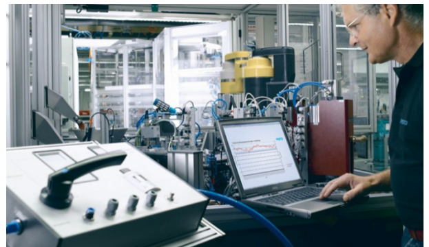
Abbildung 11: Messung des Druckluftverbrauchs
