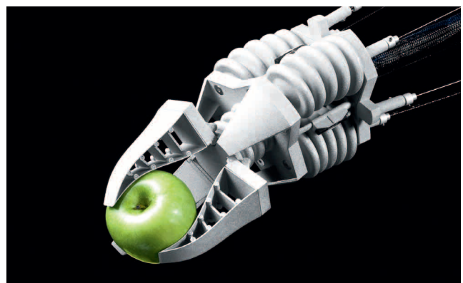
Vom Future Concept zum Serienprodukt: adaptiver Greifer DHDG
