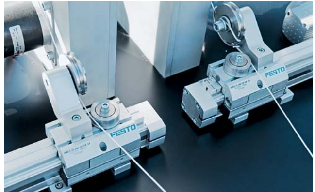
Verlegeachse mit Umlenkrollen
