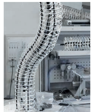
Prototypen pneumatischer Leichtbaustrukturen (von links nach rechts): Schematische Darstellung der Auslenkbewegung, 4-Kammer-System mit versetzten Muskelsträngen, Aneinanderreihung linearer Auslenkelemente, 4-Kammer-System mit Sensorik
