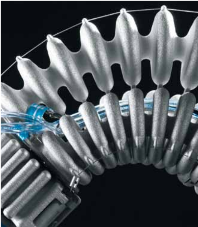
Höhere Performance durch niedrigeres Gewicht: Leichtbaustruktur des Greifarms
