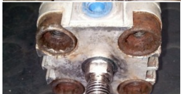
Mala elección del material: daños habituales
