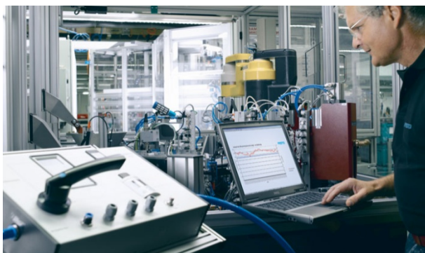
Figura 10: Medición del consumo de aire comprimido
