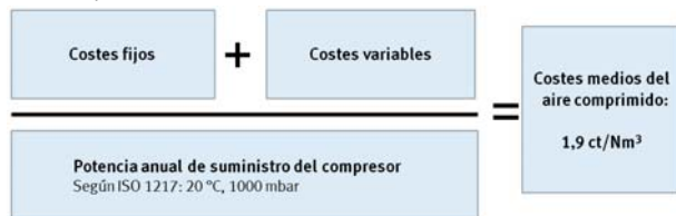
Figura 1: Cálculo de los costes medios del aire comprimido
