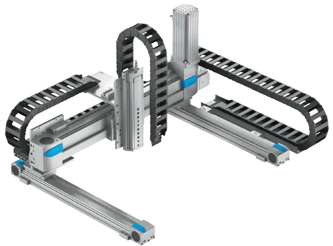
Figura 4: "Best of both Worlds": accionamientos eléctricos para posicionado flexible para movimientos X e Y, diseño compacto de actuadores neumáticos con rendimientos más altos para el eje Z
