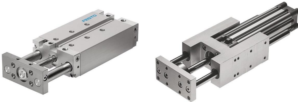
Figure 1. Un actionneur avec guidage comme le DFM de Festo (à gauche) comprend des tiges de guidage intégrées et ne nécessite aucun assemblage tandis qu'une unité de guidage comme la FENG de Festo montée sur un vérin standard (à droite) nécessite une opération d'assemblage supplémentaire.
