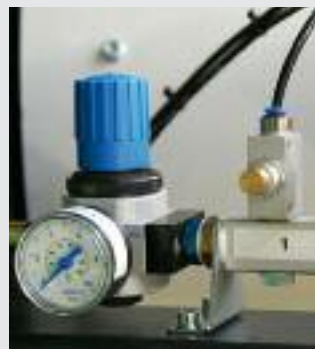
Druckregler der D-Reihe und Drosselventile montiert auf einer PAL-Anschlussleiste zur kontrollierten Versorgung der Separation am Schwingtopf.
