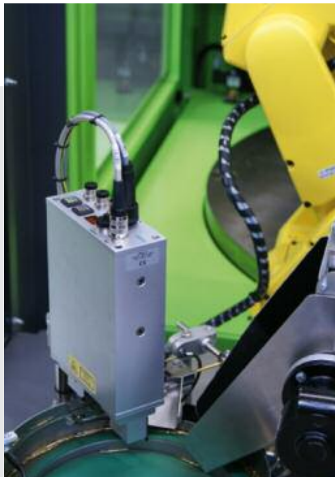
Die Checkbox Compact PLC von Festo sorgt für eine zuverlässige Vorabkontrolle der Stifte.
