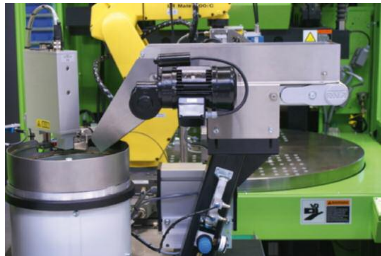
Von Nexus entwickelte Automatisierungslösung für die Zuführung von Kontaktstiften im Vorfeld der Spritzgussanlage.
