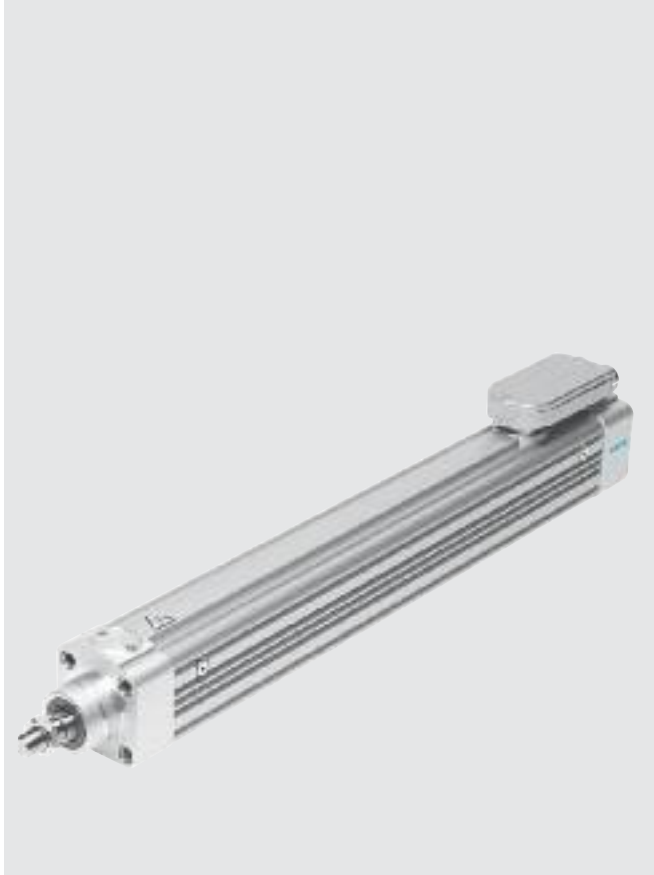
Beim Linearmotor-Zylinder DNCE-LAS bilden alle erforderlichen Komponenten wie Linearmotor, Messsystem, Führung und Referenzschalter eine einsatzbereite Achse.
