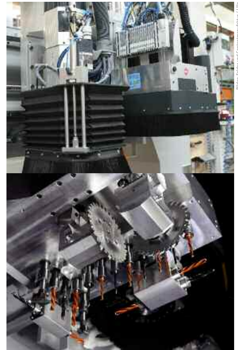
Bearbeitungskopf der Maschine mit der Frässpindel links und dem Mehrspindelbohrkopf rechts im Bild.
