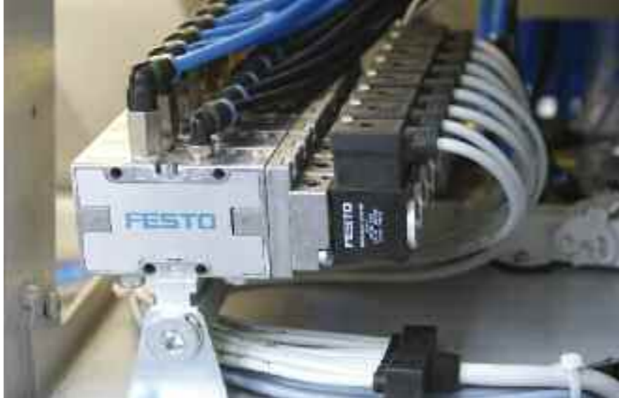
MFH-Sitzventile steuern die Werkstückanschläge und die Einlagehilfen, auf die die Werkstücke beim Einlegen platziert werden.
