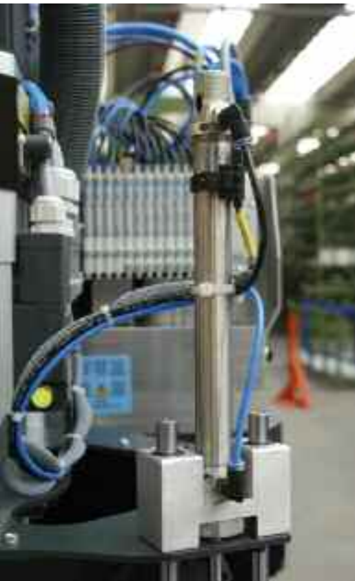
DSNU-Rundzylinder senken die an der Frässpindel angebrachte Absaugereinheit ab.
