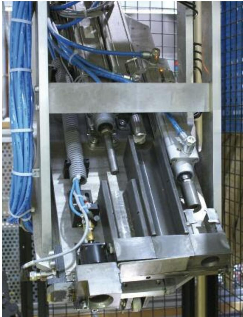
CLR-Schwenkspanner fixieren den Klimaverflüssiger während der Montage und der Stickstoff-Druckprüfung.
