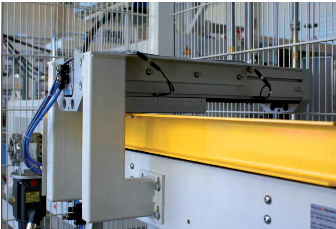
**Ein DGP-Zylinder mit Schwerlastführung HD** schiebt die verpressten Rohprodukte vom Förderband durch eine Öffnung im Schutzzaun auf eine Rutsche, von der sie für eine Qualitätskontrolle händisch entnommen werden können.
