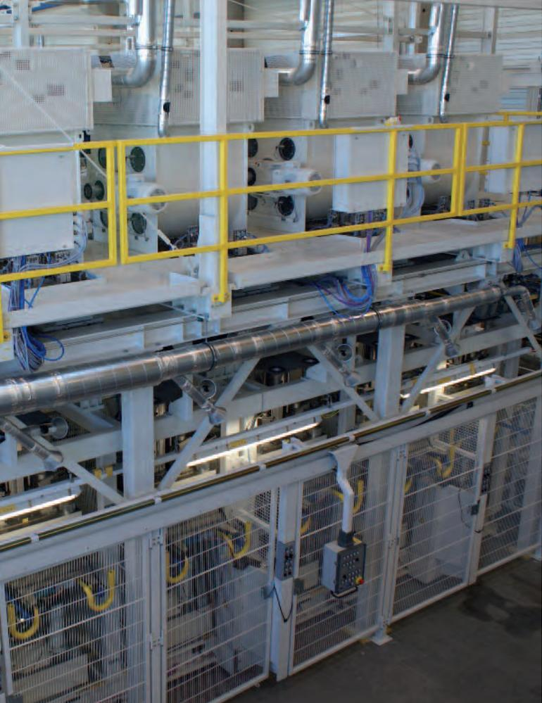
**Pneumatik sorgt für das Vorverdichten des Rohmaterials** – Wartungsgeräte der D-Reihe, CPV-Ventilinsel ein 5/3 Wegeventil VL in diesem Bereich der Maschine.
