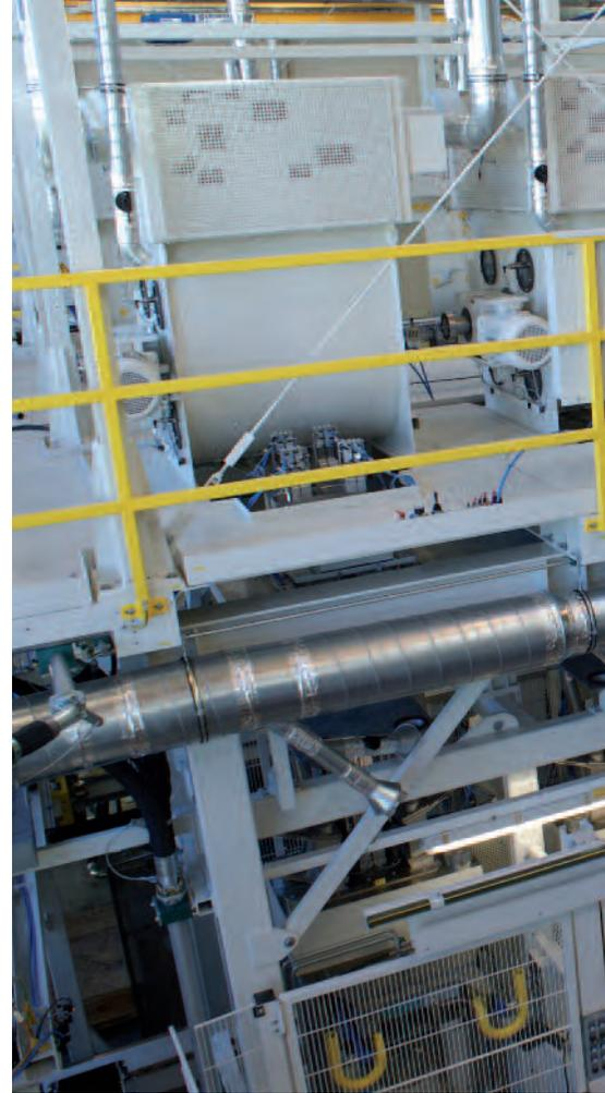
Anlage zur Fertigung von Reibbelägen.
