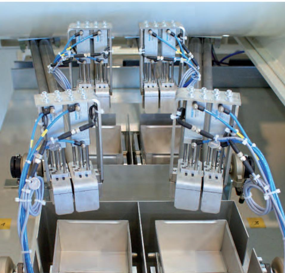
DSRI-Drehzylinder und ADNG-Kurzhubzylinder mit Verdrehsicherung öffnen die Zufuhr für die Grob- und Feindosierung der Wiegebehälter.
