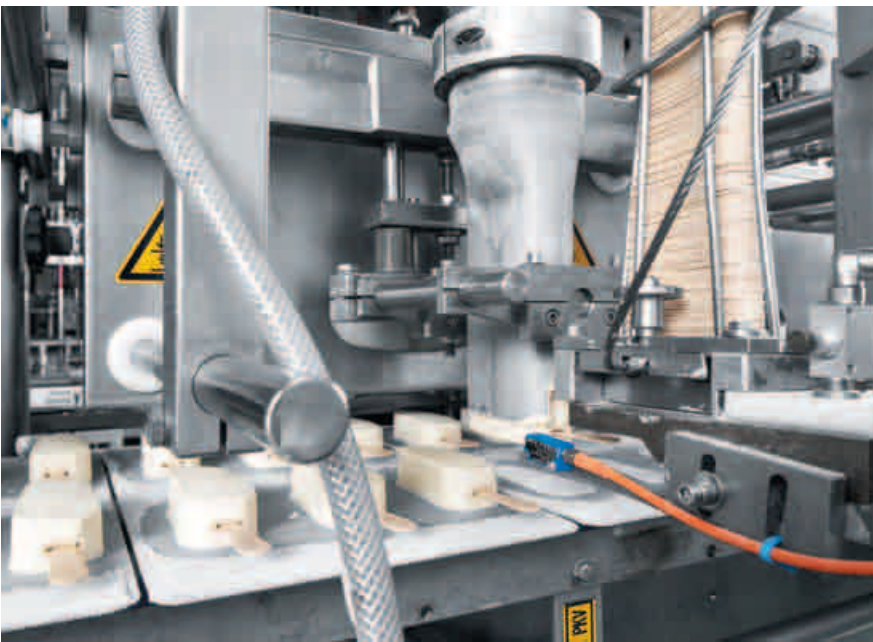
Perfekt portioniert: Im Sekundentakt verlassen den Extruder die Herzstücke der Magnum-Herstellung. Das Eis wird beim Extrudieren gleich mit dem Stiel versehen.
