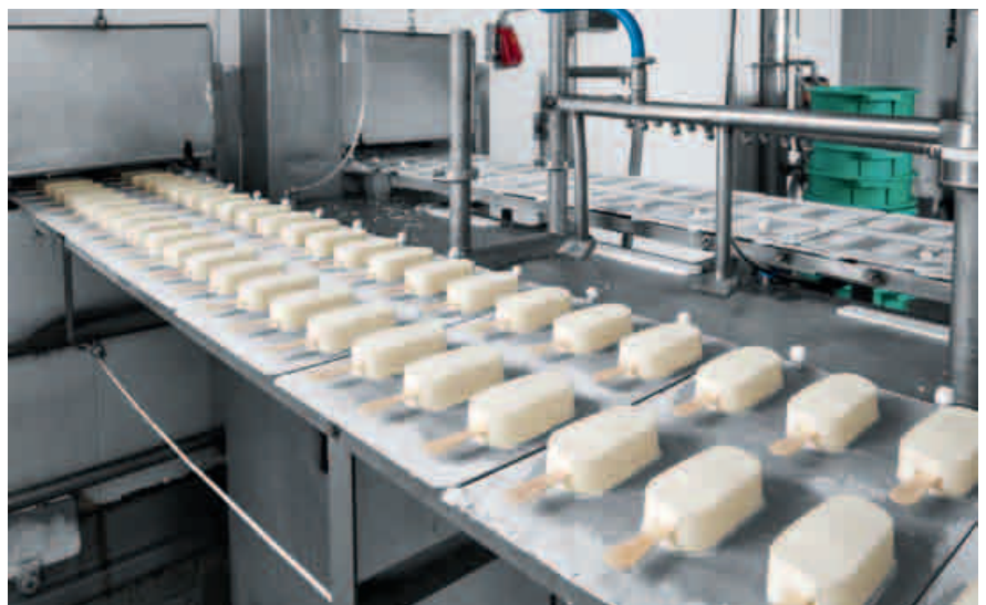
Am laufenden Band: Mehr als 20.000 Stück produziert eine von fünf Magnum-Anlagen in der Stunde.
