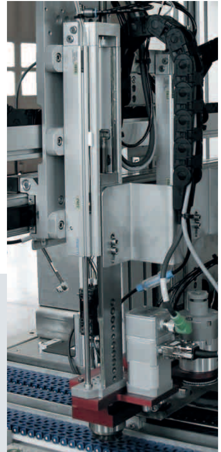
Das Handling, von Festo vormontiert geliefert, legt die Rohlinge zum Blocken einzeln in die Aufnahme.
