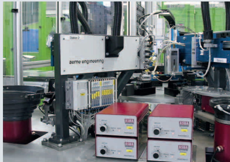
Montageautomat: Ein Wendelförderer vereinzelt die Metallplättchen und Gummipuffer und setzt sie lageorientiert in das Spritzgussteil ein (oben).
