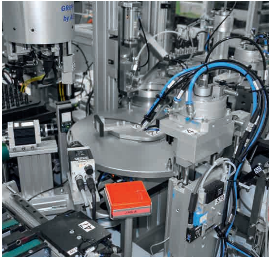
Les caméras intelligentes de type SBOC-Q assurent le contrôle de la qualité.
