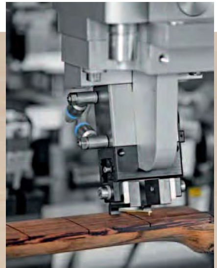
Avec une précision au centième de millimètre , la machine Minikomp insère les frettes dans la touche.
