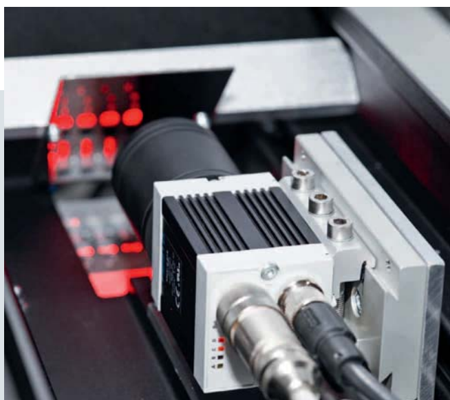
Contrôle qualité à l'aide du système de vision SBO..-Q Festo.
