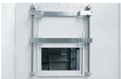
Blitzschnelle Falltür: Das 90 kg schwere Schott schließt in 0,6 Sekunden und wird im letzten Moment durch einen Dämpfungsblock abgebremst.
