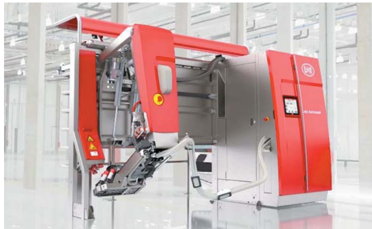
РИС. 3. ◀ Новый доильный робот компании Lely Astronaut A5 — совместный продукт компаний Festo и Lely, разработанный в рамках проекта Astronaut Milking Robot
