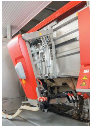
РИС. 4. ◀ Гибридная рука доильного робота компании Lely Astronaut A5 — совместная разработка компаний Festo и Lely
