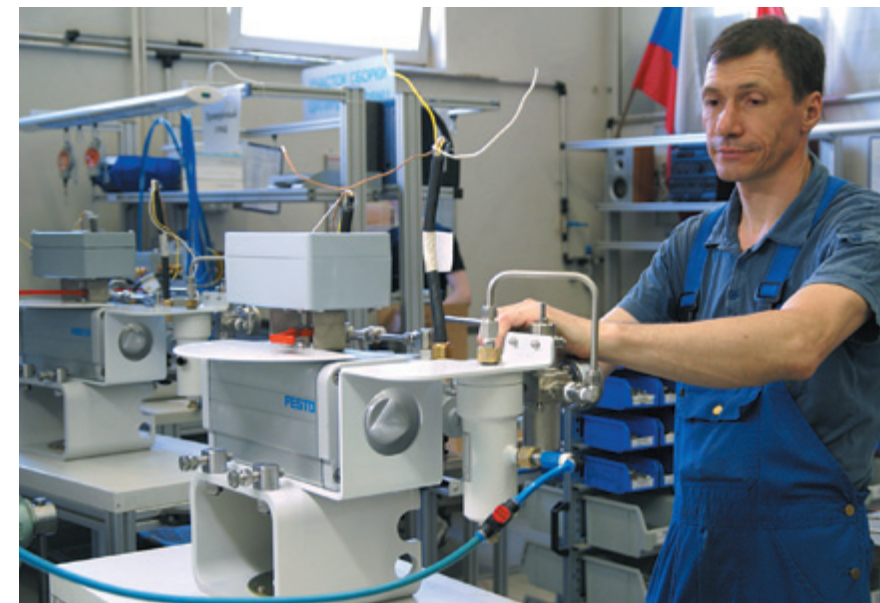
Сборка и тестирование системы GBVA/DAPS
