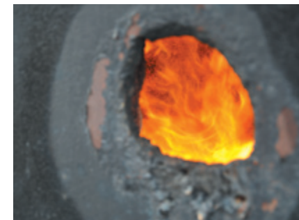
Воздействие открытого пламени на систему GBVA/DAPS
