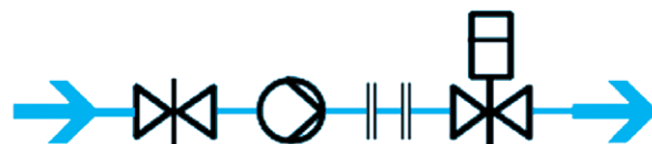
Рис. 2. Принципиальная гидравлическая схема с применением пневмопривода
