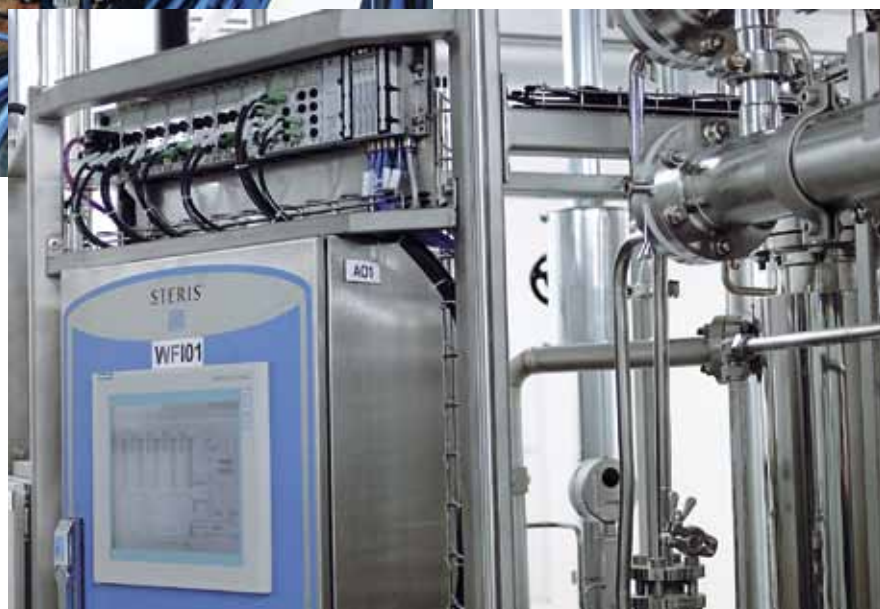
A Steris Finn-Aqua higiéniai technológia gyártó Festo CPX/MPA szelepszigeteket alkalmaz a gyógyszeripar számára történő ultra nagy tisztaságú víz előállításához használt többfokozatú vízdesztilláló berendezéseiben.
